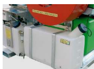
Veloce sistema di lavaggio per il circuito irrorante.
